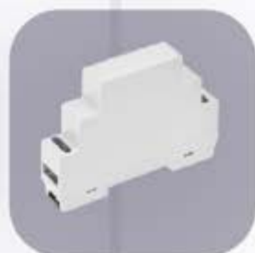
Z105 MATERIAL: PS/ ABS VO H / W / L [mm]: 64,9 / 17,5 / 90 AVAILABLE COLOURS: ■ ABS VO ■ PS/ ABS VO
