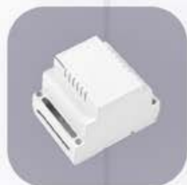
Z100 MATERIAL: PS/ ABS VO H / W / L [mm]: 64,7 / 69,7 / 89,3 AVAILABLE COLOURS: ■ ABS VO ■ PS/ ABS VO
